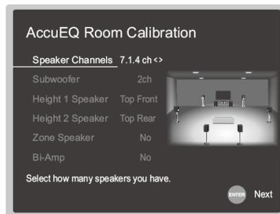
屏幕上的图像会随着您在"Speaker Channels"中选择的声道数而更改，在进行设置时请参见图像。
